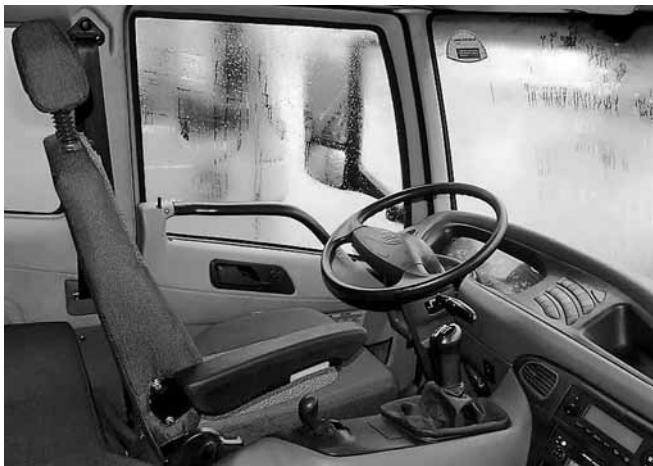
**Водительское кресло с пневматической подвеской и возможностью регулировки сиденья в соответствии с весом сидящего за рулем**
