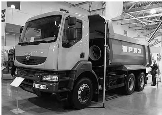
Рис. 7. Самосвал КрАЗ-С20.2R комплектуется кабиной от Renault Kerax
