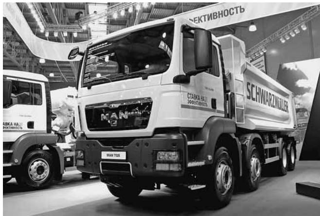
Грузовой автомобиль MAN TGS с самосвальным кузовом Schwarzmüller
