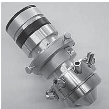
Рис. 1. Форсунка семейства "Coax Powerline" с коаксиальной подачей порошка
