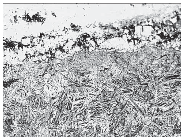
Рис. 3. Микроструктура подложки из стали 40X с покрытием, нанесенным на поверхность электроимпульсным припеканием ( \times 400 )
