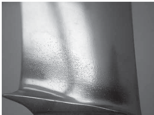
Рис. 1. Внешний вид лопатки из сплава ВТ9, подвергнутой обработке СИЭП четырьмя импульсами при энергии электронов 120 кэВ, длительности импульса 30 мкс и плотности энергии в пучке 18...20 Дж/см 2
