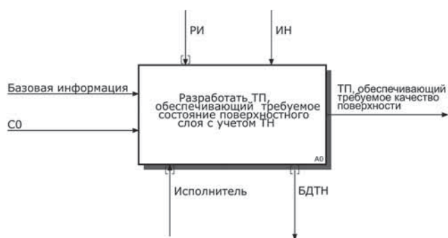
Рис. 1. Контекстная функция структурной модели проектирования упрочняющих технологических процессов
