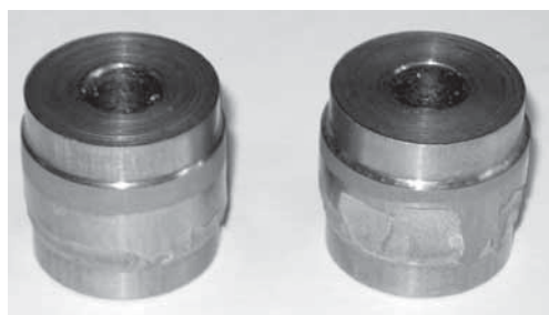
Рис. 7. Внешний вид образцов, продавленных сквозь матрицу после испытания на сдвиг
