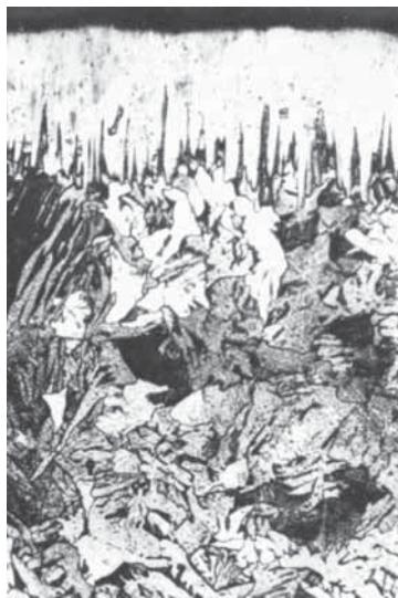
Рис. 3. Микроструктура боридного слоя в сплаве типа ХН57МВТЮ, \times 500
