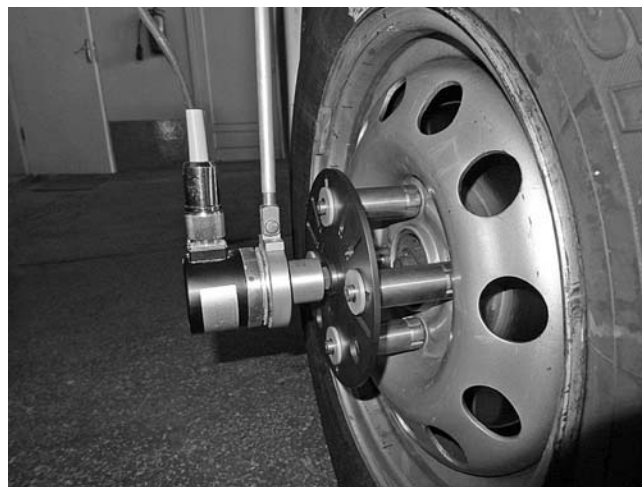
Рис. 2. Внешний выносной датчик угловой скорости колеса и его установка
