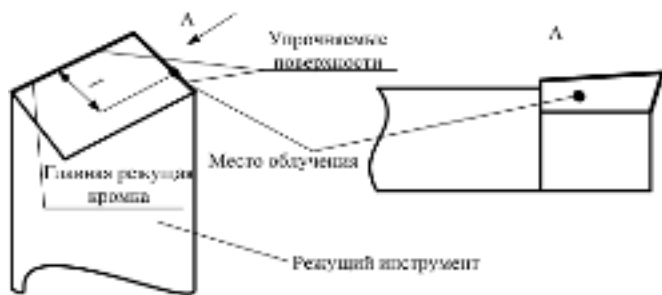
Рис. 1. Схема упрочнения режущего инструмента при использовании ОИЛУ
