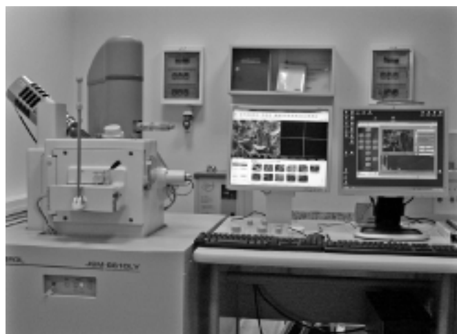
Рис. 2. Растровый электронный микроскоп JEOL JSM-6610LV
