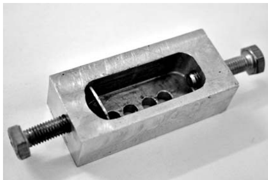
Рис. 1. Приспособление для спекания образцов
