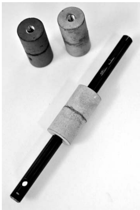
Рис. 2. Подготовленные образцы для испытаний на разрыв
