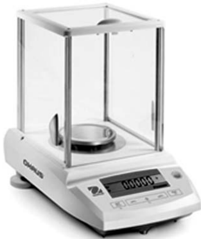
Рис. 4. Аналитические весы "Ohaus Pioneer"
