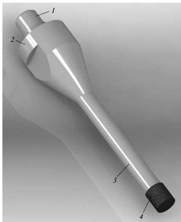
Рис. 2. Основные конструктивные элементы алмазного инструмента
