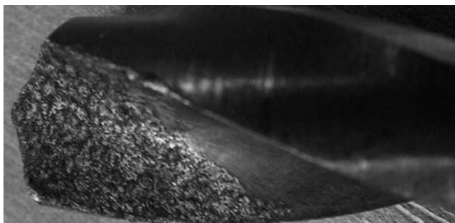
Рис. 2. Сверло с электроискровым покрытием электродом из порошка, полученного ЭЭД отходов твердого сплава Т15К6
