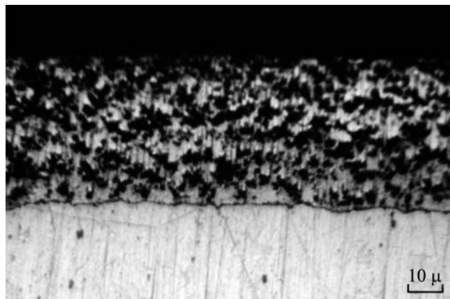
Рис. 1. Типичная микроструктура электроосажденного железного композиционного покрытия с содержанием ~30 % твердой фазы (порошок ВК8)
