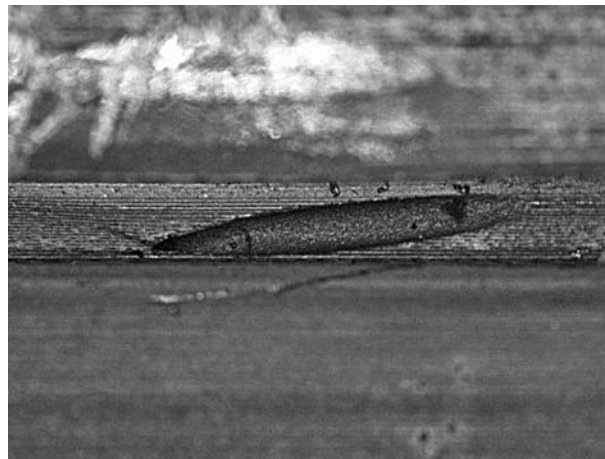
Рис. 2. Поверхность в канале после электроэрозионного прошивания
