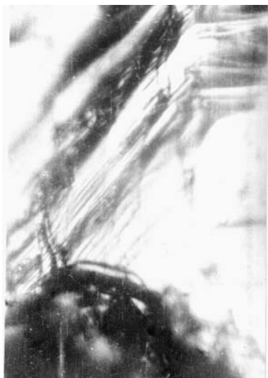
Рис. 1. Коррозионная "язва" с микротрещинами
