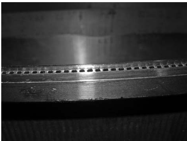
Рис. 1. Элемент системы охлаждения с мелкоразмерными щелевыми каналами
