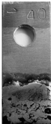
Рис. 5. Деталь с медным покрытием после нанесения припоя ПОС 40 паяльником с применением флюса СКФ
