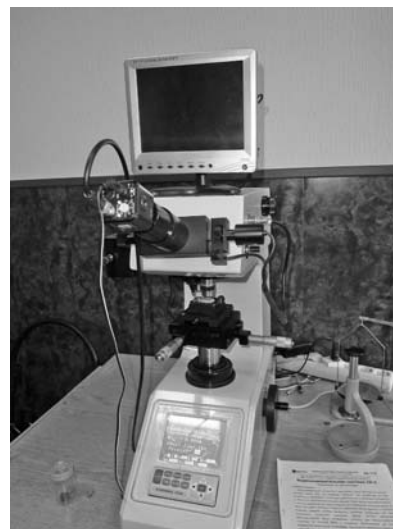
Рис. 4. Прибор для измерения твердости дорожек качения колец подшипников
