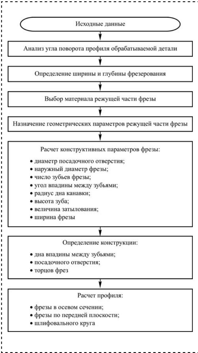
Рис. 2. Алгоритм расчета конструктивных и геометрических параметров фасонной фрезы
