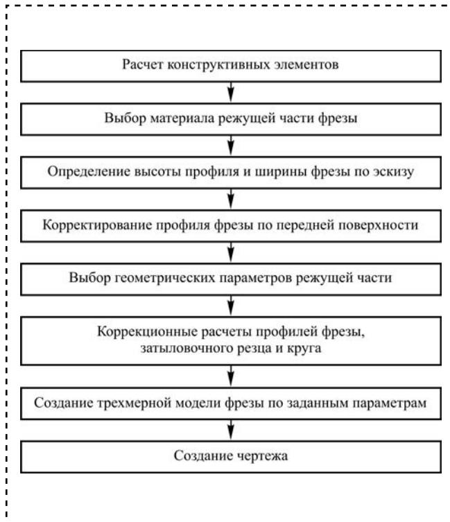
Рис. 1 . Структурная схема процесса проектирования фасонной затылованной фрезы
