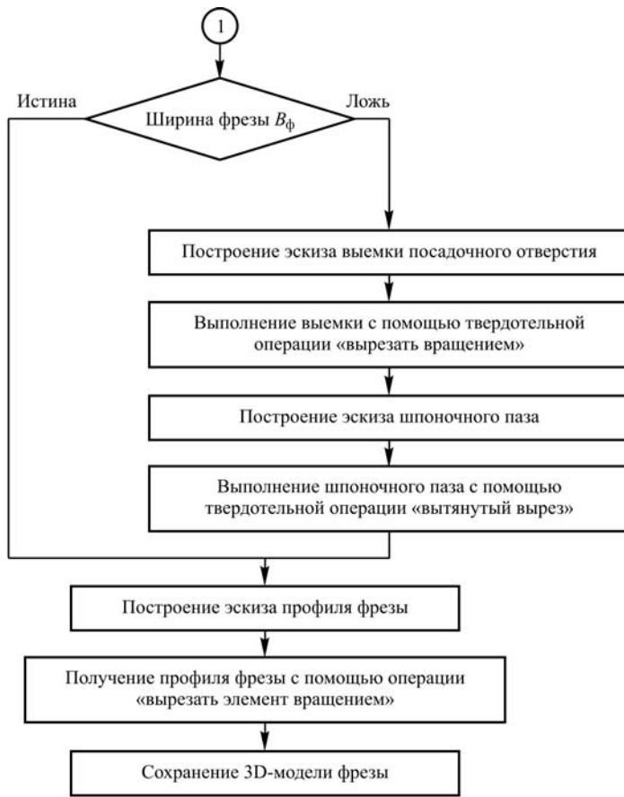
Рис. 3. Алгоритм построения трехмерной модели
