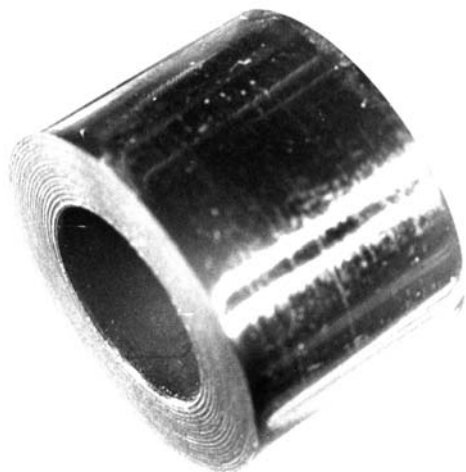
Рис. 2. Образец для испытаний на износ, на цилиндрическую поверхность которого нанесено покрытие электродуговой металлизацией
