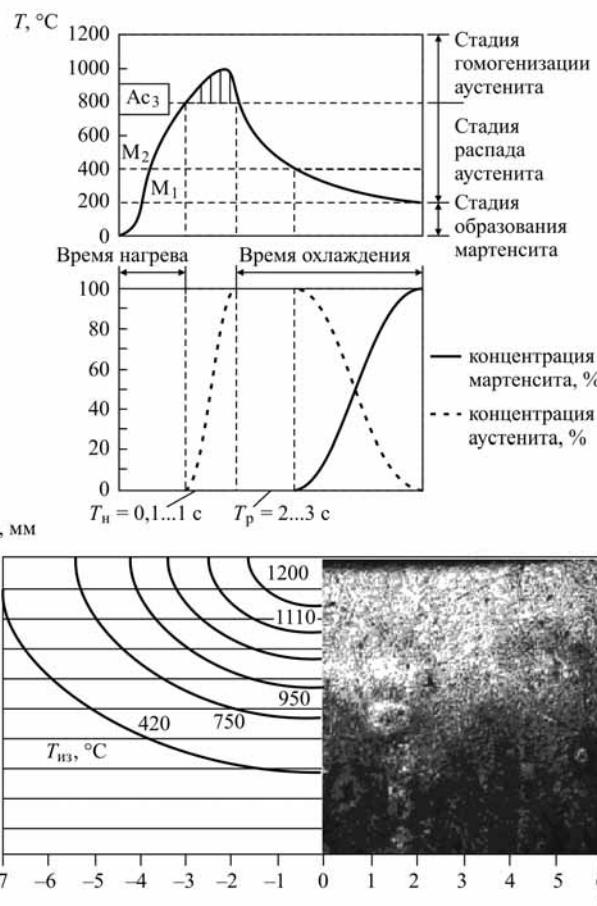
Общая схема структурных превращений при нагреве и охлаждении концентрированным потоком энергии
