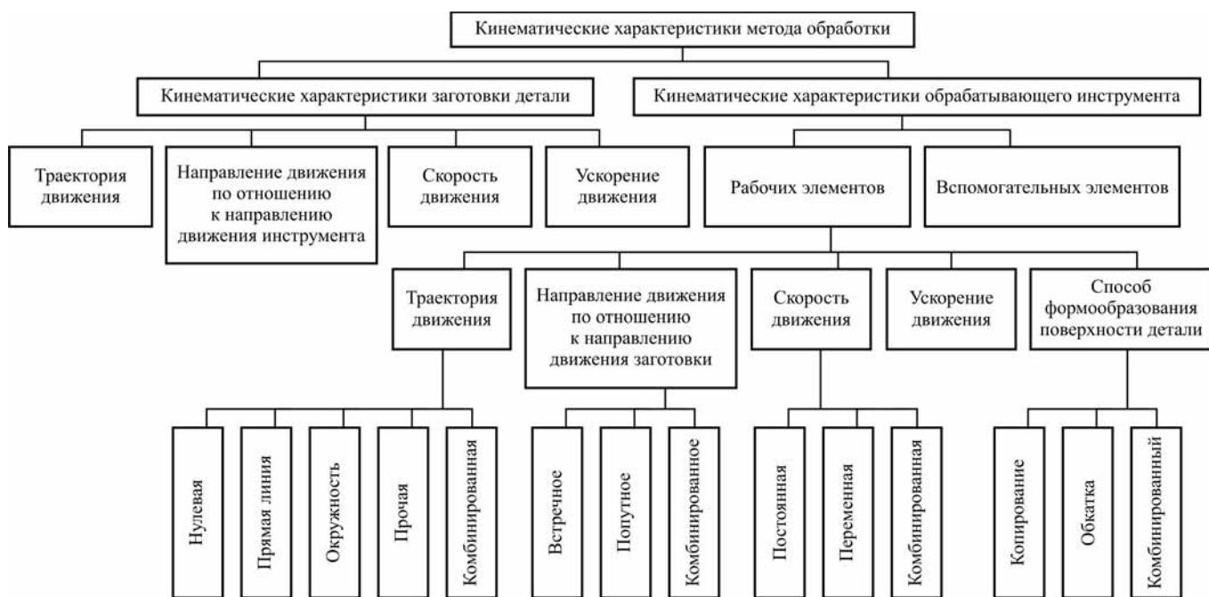
Рис. 4. Обобщенная системная модель для структурного анализа-синтеза кинематических характеристик метода обработки
