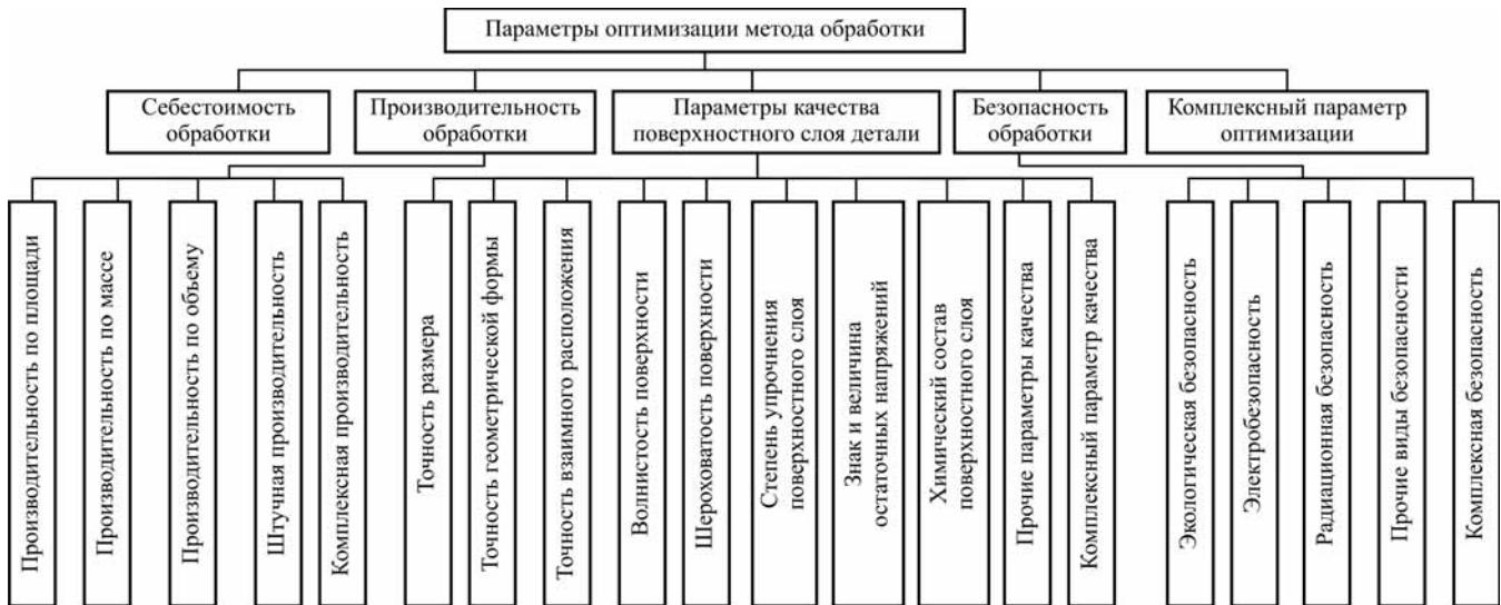
Рис. 7. Обобщенная системно-структурная модель параметров оптимизации характеристик метода обработки
