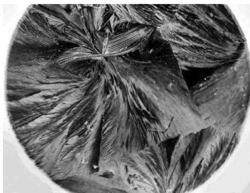
Рис. 3. Интерференционная картина оксида меди на поверхности стали 08Ю ( \times 1000 ; в монохромном свете; AXIOVERT 25CA)
