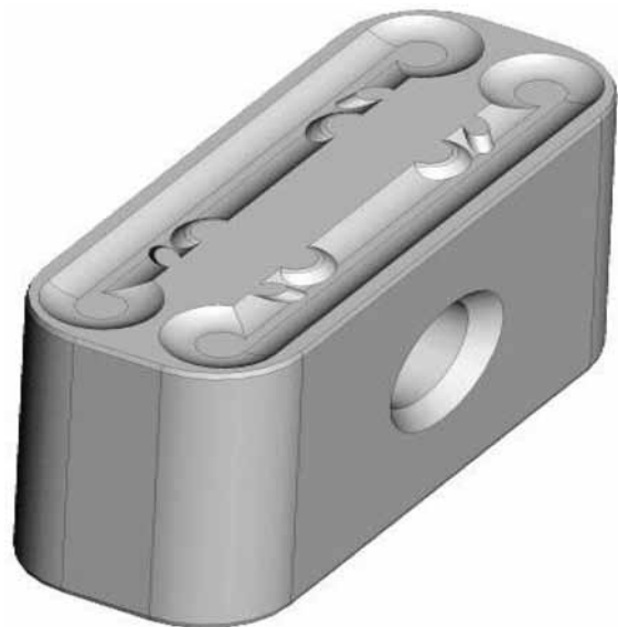
Рис. 4. Устройство пластины, у которой упрочнение достигнуто за счет переноса места долома стружки на внутреннюю поверхность стружкозавивающей канавки
