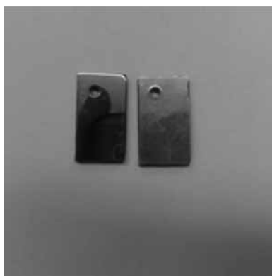
Рис. 1. Образцы до нанесения покрытия (слева Ra = 0,04 мкм, справа Ra = 0,63 мкм)
