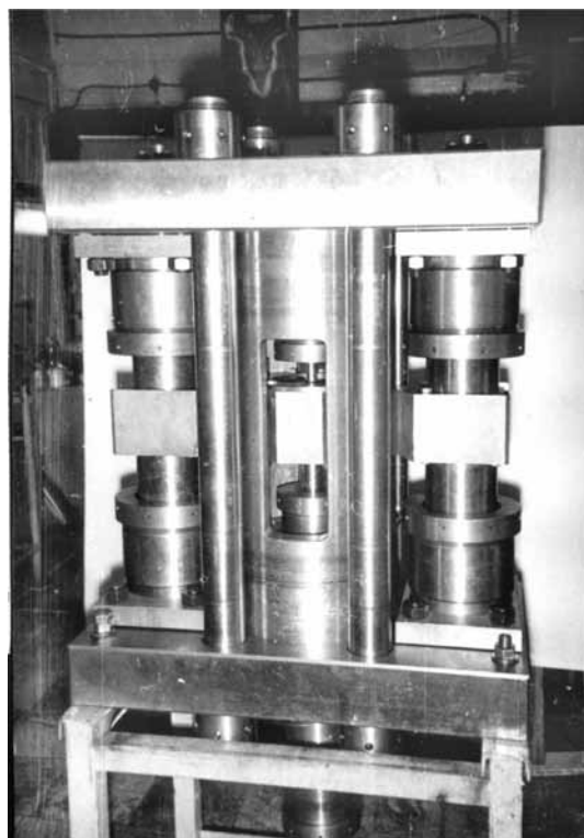
Рис. 7. Пресс для формирования порошков со сдвигами частиц силой 2 МН
