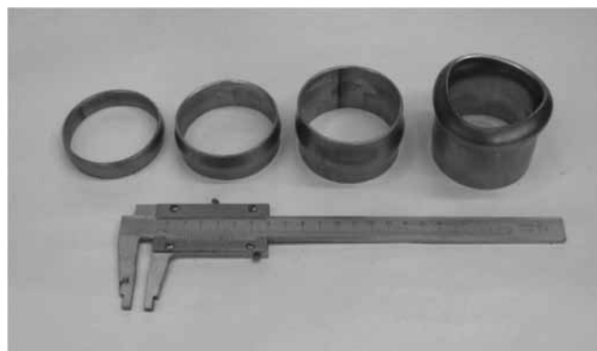
Рис. 5. Примеры потери устойчивости разных по высоте трубных заготовок
