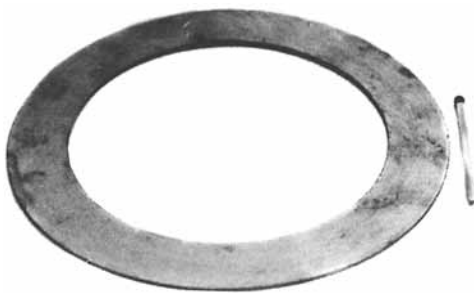
Рис. 2. Кольцо из порошковой стали, сформованное в штампе
