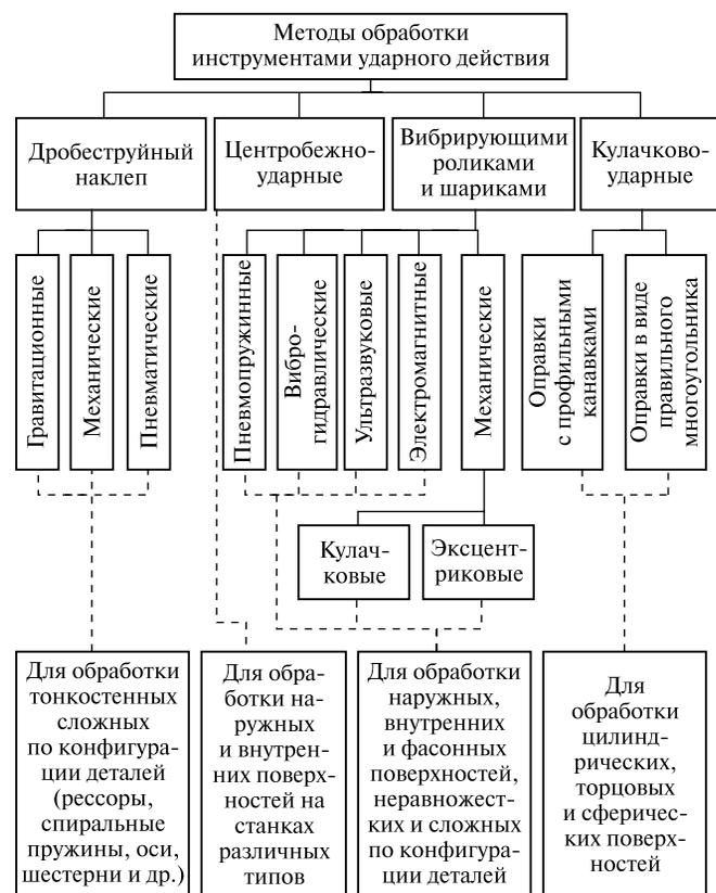
Рис. 6. Классификация и область применения импульсных методов обработки инструментами ударного действия
