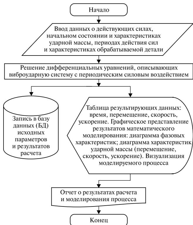
Рис. 8. Блок-схема алгоритма моделирования устойчивости процесса ударно-импульсной обработки
