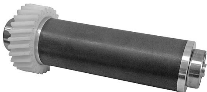
Рис. 10. Вал печатной машины с защитным детонационным покрытием из Cr_2O_3 толщиной 300 мкм
