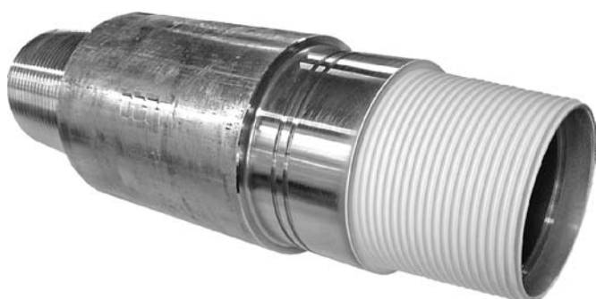
Рис. 9. Ниппель буровой колонны с резьбой, изолированной детонационным покрытием из Al_2O_3 толщиной 300...700 мкм
