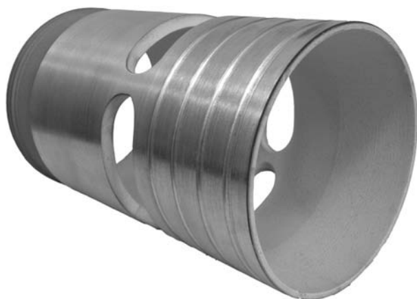
Рис. 11. Жаровый канал с огнезащитным детонационным покрытием из YSZ толщиной 500 мкм на подслое из NiCrAlY
