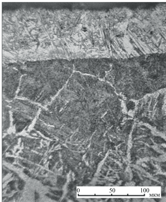
Рис. 1. Микроструктура поверхностного слоя после диффузионного молибденирования
