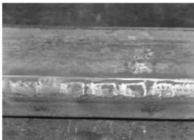
Рис. 10. Дефекты после упрочнения при высоком расходе газа
