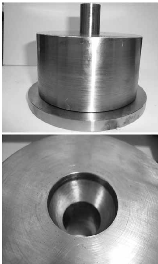
Рис. 1. Экспериментальная пресс-форма для изучения процесса уплотнения при реализации интенсивного сдвига
