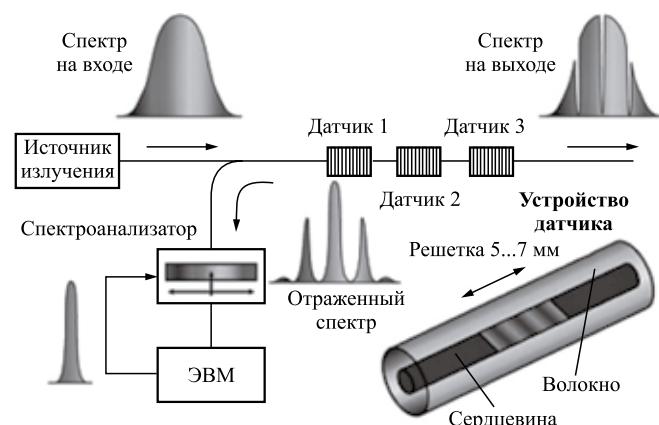
Рис. 1. Принципиальная схема измерений с применением волоконно-оптических датчиков
