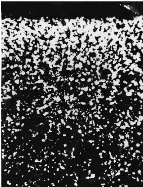
Рис. 1. Микроструктура стали с 3,1 % ат. Cr ( \times 500 )
