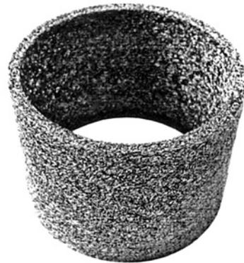
**Рис. 7. Тонкостенный УПЭ, полученный радиально-осевым прессованием полиуретаном**
