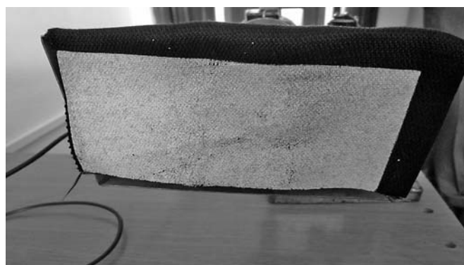
Рис. 5. Экран из углеродного волокна с плазменным покрытием
