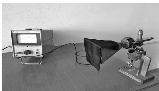
Рис. 4. Приемная антенна с детекторной секцией с экраном из углеродного волокна без плазменного покрытия (справа) и измерителем амплитуды поля (слева)
