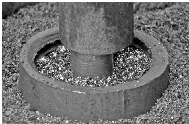
Рис. 3. Первый этап микродугового нагрева — фото-съемка в режиме AUTO
