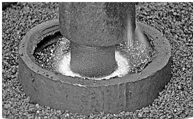
Рис. 6. Второй этап микродугового нагрева — фотосъемка в режиме Tv с приоритетной выдержкой 1/8000 с
