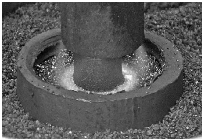
Рис. 8. Второй этап микродугового нагрева — снимок получен в режиме видеосъемки с частотой 50 кадров в секунду
