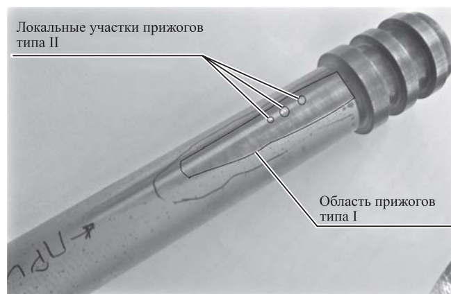
Рис. 2. Деталь с прижогам после травления
