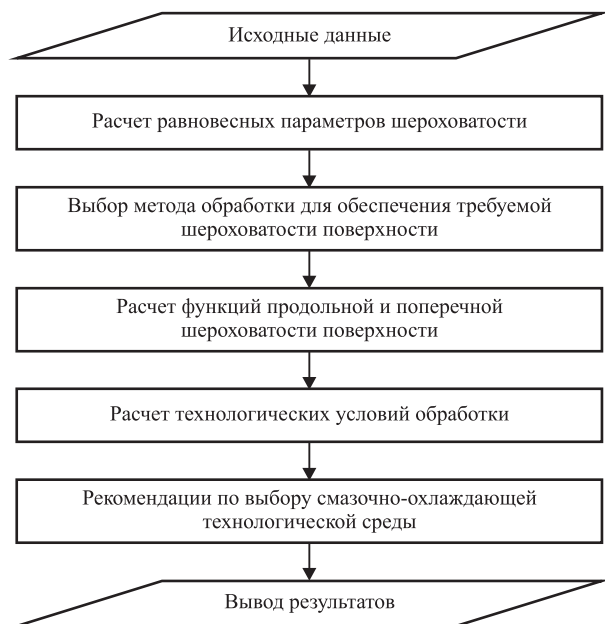
Рис. 7. Алгоритм методики технологического обеспечения равновесных параметров качества (трехмерной шероховатости и степени наклепа) на этапе конструкторско-технологической подготовки производства с учетом ГОСТ Р ИСО 4287—2014 и ГОСТ Р ИСО 25178-2—2014
