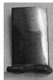
Рис. 6. Лопатка после ремонта методом наплавки торца пера
