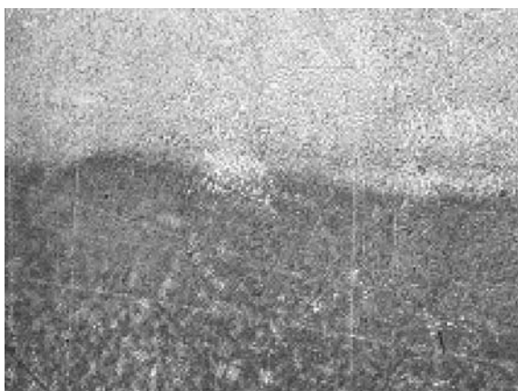
Рис. 15. Микроструктура материала наплавки после травления
