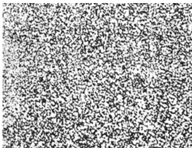
Рис. 9. Микроструктура основного материала (VT3-1)
