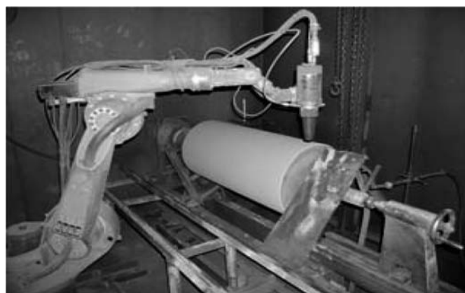
Рис. 8. Установка для высокоскоростного сверхзвукового газопламенного напыления
