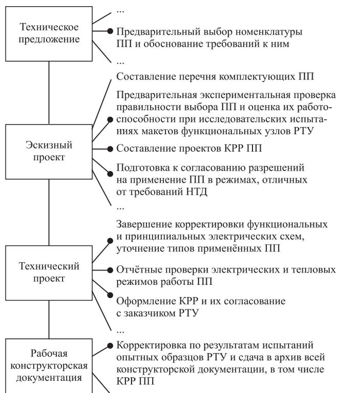
Рис. 3. Этапы работы по обеспечению надёжности ПП, выполняемой на различных стадиях разработки РТУ
