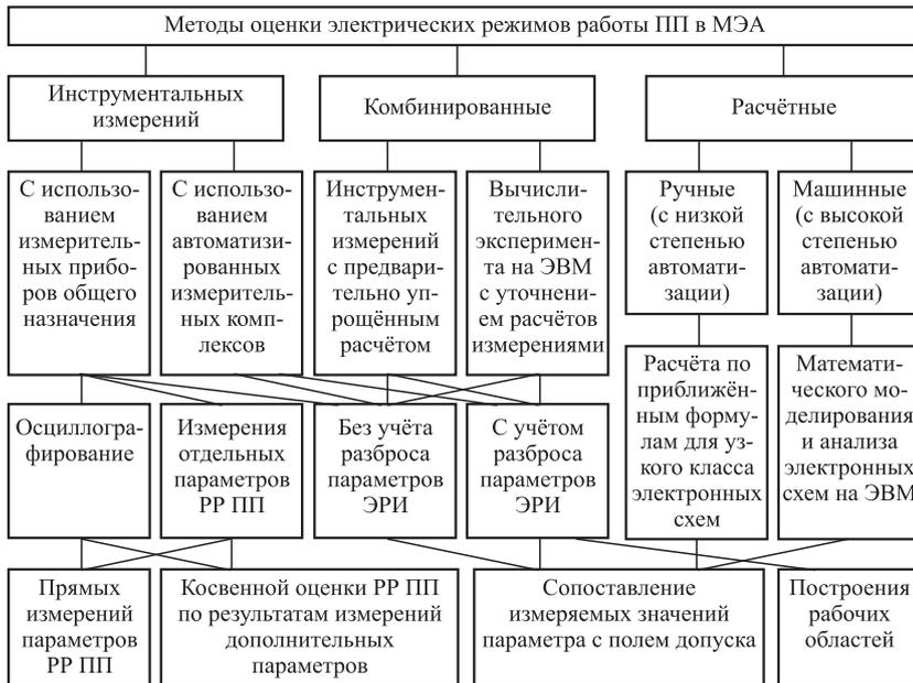
**Рис. 4. Классификация методов оценки электрических режимов работы ПП в схемах МЭА**
