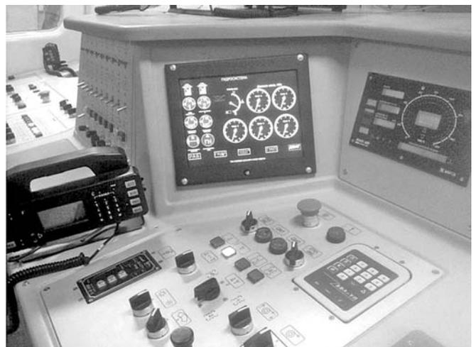
**Рис. 1.** Бортовая система мониторинга и анализа технического состояния путевой машины РПБ-01
