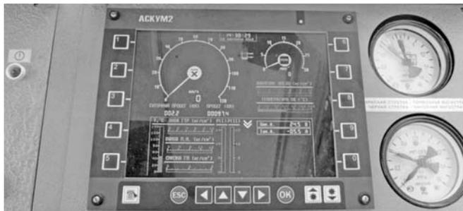
Рис. 2. Автоматизированная система контроля параметров и управления путевых машин (АСКУМ)
