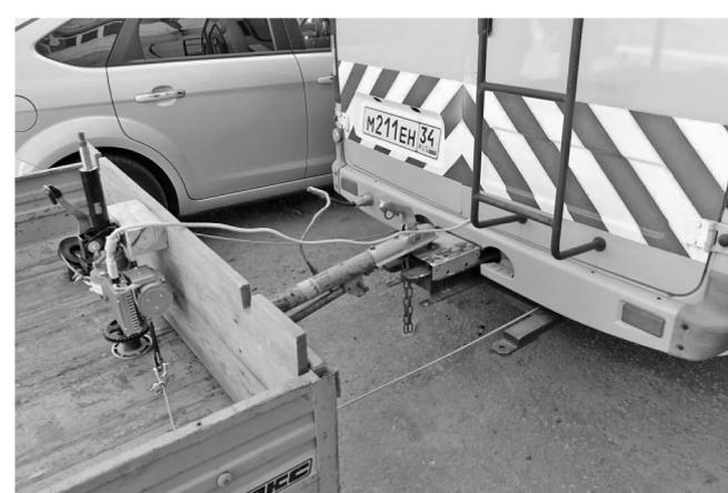
Рис. 2. Общий вид образца автопоезда с гибкой связью в сцепном устройстве
