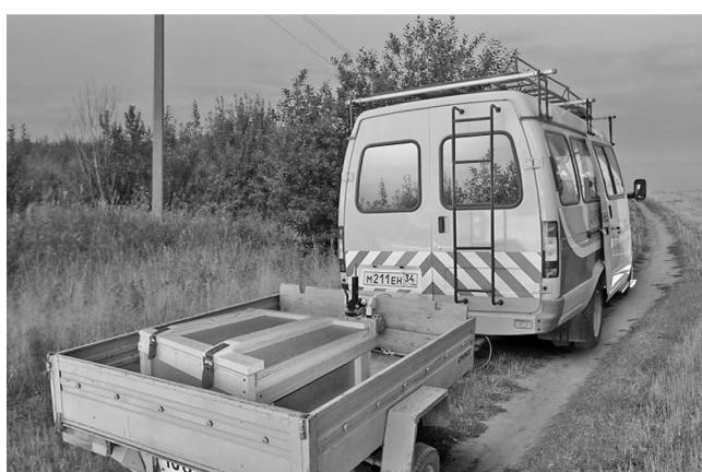
Рис. 8. Испытания малотоннажного автопоезда с гибкой связью в сцепном устройстве на просёлочной дороге
