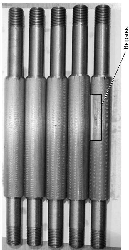
Рис. 5. Характерный внешний вид образцов-деталей из стали Ст3 после резания в направлении предварительного деформирования
