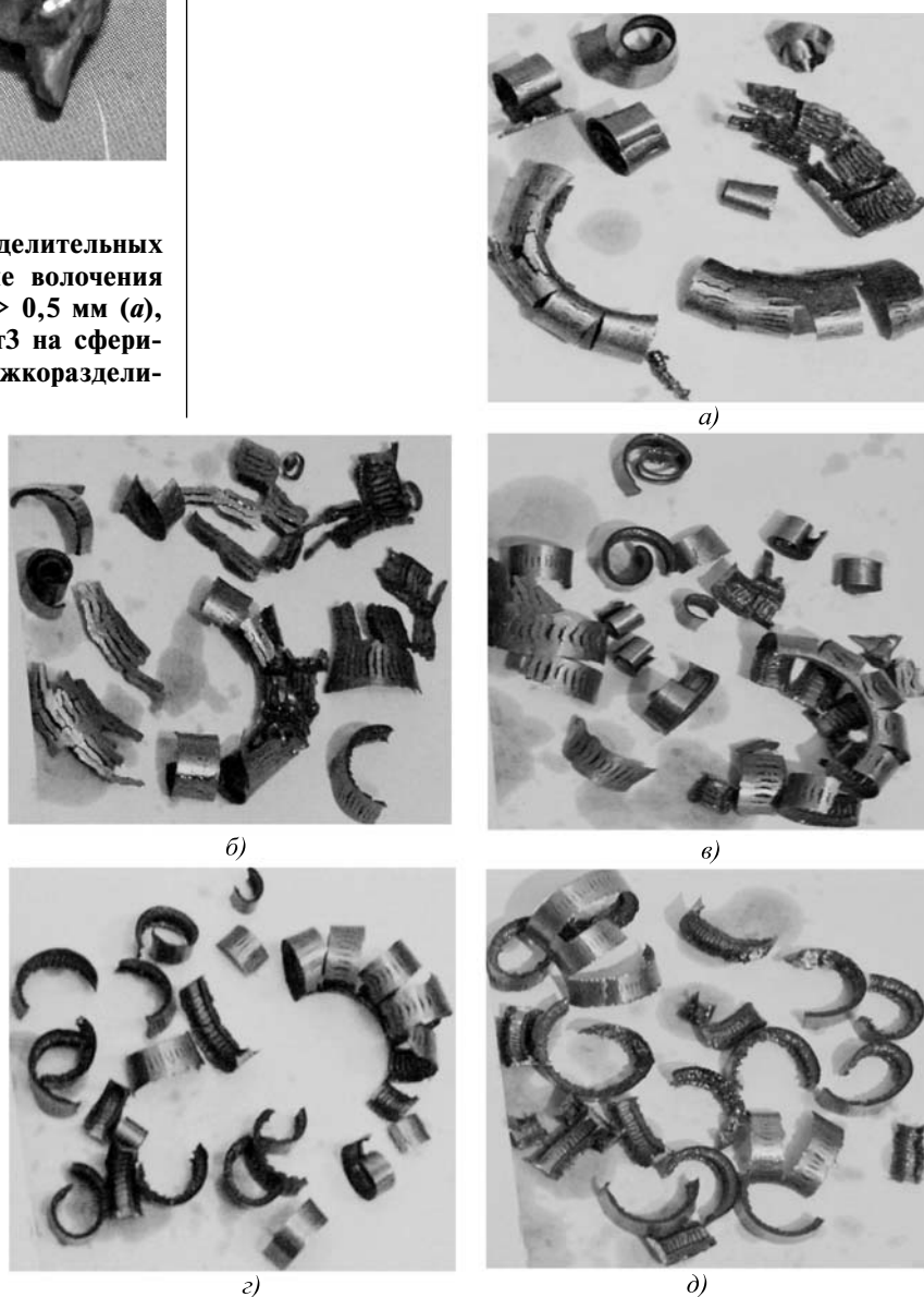
Рис. 6. Характерный внешний вид стружки, образующейся после резания образцов-заготовок из стали Ст3 в направлении предварительного деформирования:
