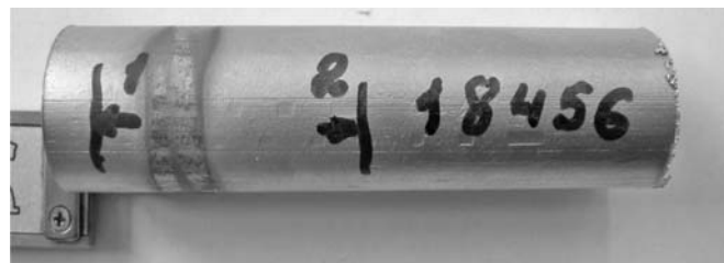
Рис. 1. Образец из стали с хромовым покрытием (рег. № 18456) после МИО с указанием вырезки сечений 1 и 2
