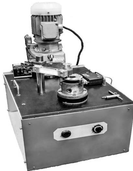
Рис. 3. Машина трения для проведения триботехнических испытаний
