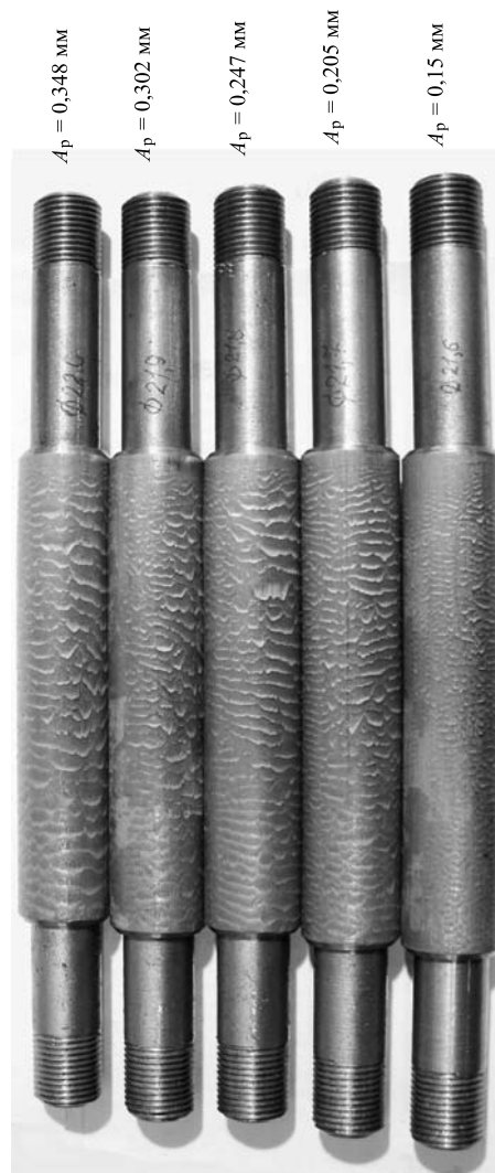
Рис. 2. Образцы-детали из стали Ст3, обработанные режущим волочением без предварительного деформирования
