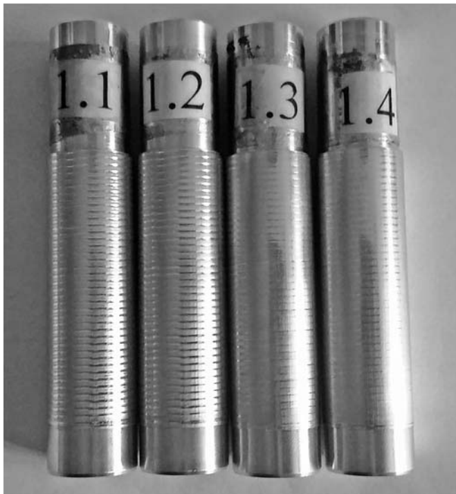
Рис. 7. Образцы-детали, полученные при ОПД образцов-заготовок с РМР поверхности
