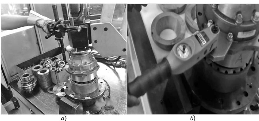
Рис. 12. Окончательный этап сборки подшипникового узла с преднатягом — резьбозатяжная операция на гайке хвостовика ведущей шестерни (а) и контроль точности преднатяга по моменту трения (б) с помощью динамометрического ключа
