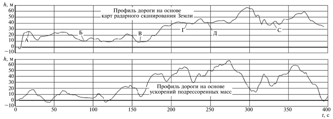
Рис. 4. Сравнение продольных профилей на основе радарного сканирования Земли и интегрирования ускорений и углов дороги
