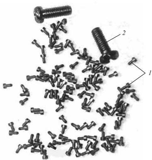
Рис. 1. Винты для сборки механических часов M0,5×1,4 (1) и винты с резьбой M2,0 (2)
