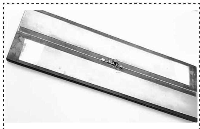
Рис. 8. Метка для металла на базе отечественной микросхемы
