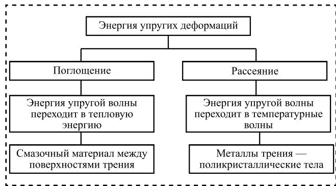
**Рис. 5. Схема преобразования энергии упругой деформации в паре трения со смазочным материалом**
