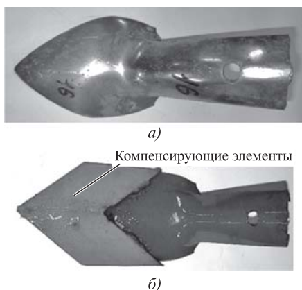
Рис. 1. Стрельчатая культиваторная лапа: a — предельно изношенная; б — восстановленная методом компенсирующих элементов
