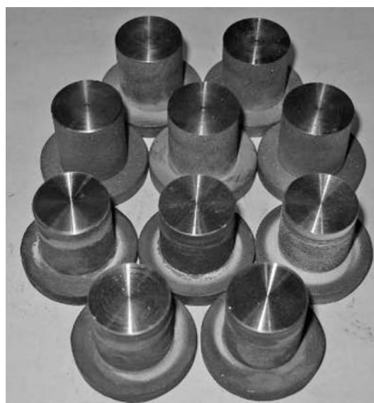
Рис. 3. Образцы для контроля адгезионной прочности покрытия
