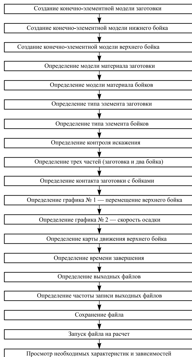
Рис. 8. Блок-схема процесса создания конечно-элементной модели в среде LS-Dyna
