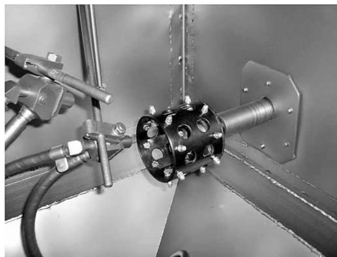
Рис. 3. Имитатор вогнутой поверхности с плоскими образцами в камере струйно-динамической установки
