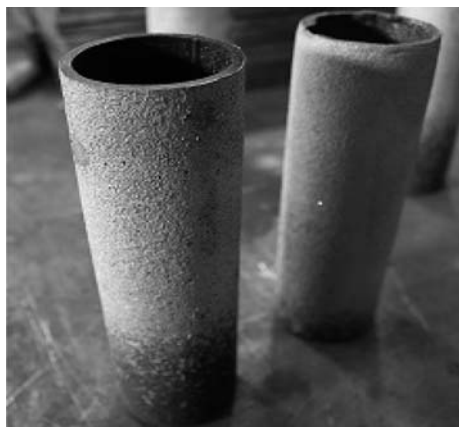
Рис. 1. Образцы после нанесения алюминиевого покрытия
