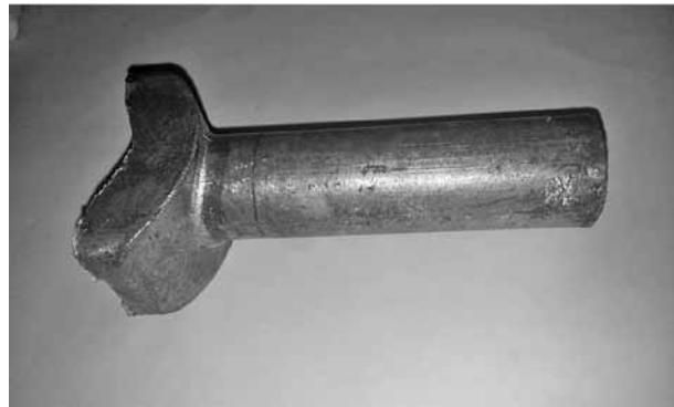
**Рис. 4. Заготовка после высадки**
