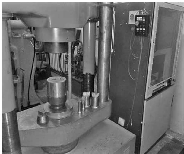
Рис. 1. Испытательная машина EU-100 и экспериментальный штамп для высадки стержневой детали
