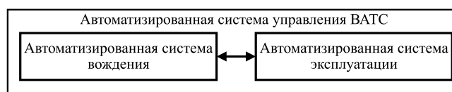
Рис. 1. Структурная схема автоматизированной системы управления высокоавтоматизированного транспортного средства
