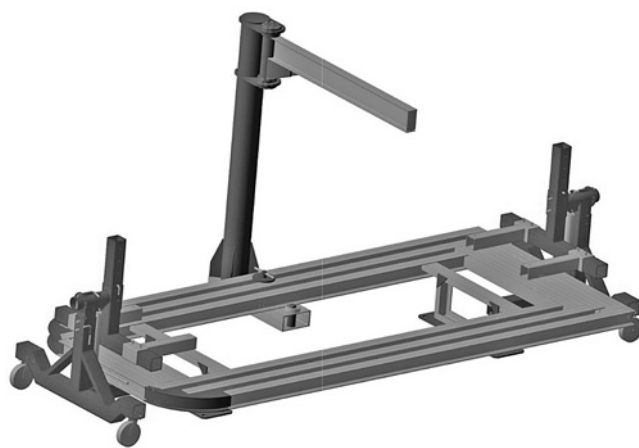
Рис. 4. Универсальный сборочный комплекс ЯГТУ для сборки автомобиля
