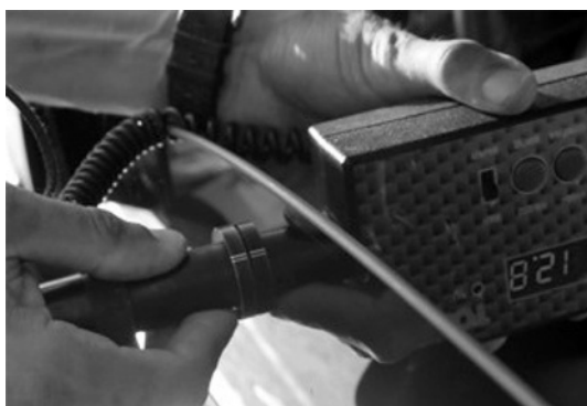
Рис. 3. Измерение светопропускания экрана фары
