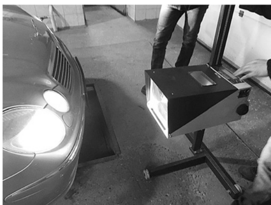
Рис. 6. Измерение величины силы света фар
