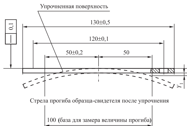
Рис. 3. Образец из стали 30ХГСА
