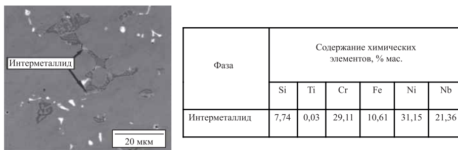
Рис. 9. Микроструктура сплава HP40NbTi в обратно-отраженных электронах в ЗТВ вблизи 2-го валика металла шва сварного соединения и химический состав интерметаллида
