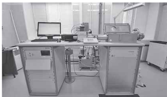
Рис. 3. Образец \varnothing 5 \times 10 мм (а) и dilatometer DIL 805 A/D (б)
