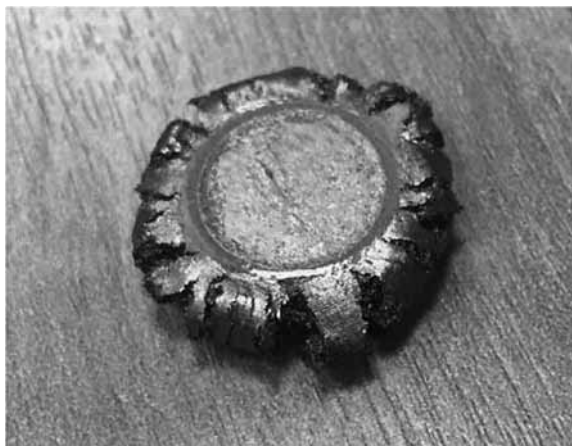
Рис. 7. Разрушения образца при испытаниях на пластичность при повышенных температурах
