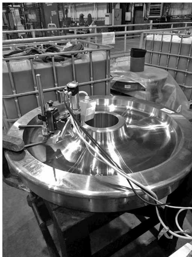
Рис. 3. Определение остаточных напряжений в поверхностном слое железнодорожных колес АО "ЕВРАЗ НТМК" в условиях цеха с применением портативного рентгеновского дифрактометра ДРП
