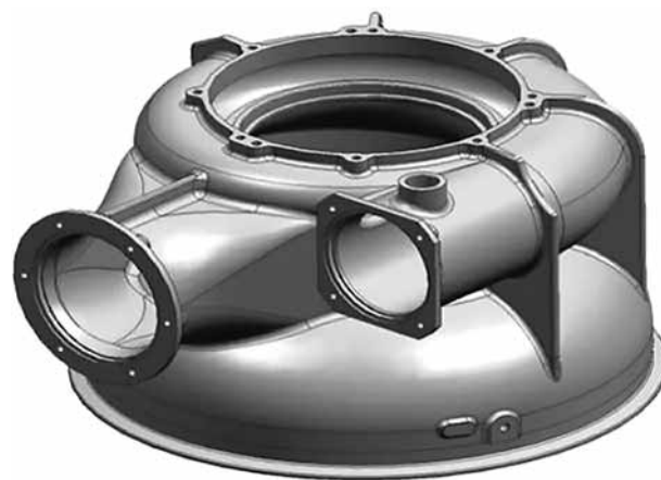
Фрагмент 3D-модели детали "корпус турбокомпрессора"
