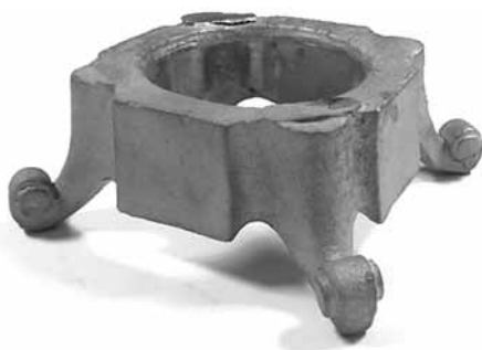
Рис. 5. Отливка "поддон" при использовании ЛПС № 4
