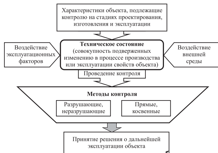
Рис. 1. Схема реализации комплексной диагностики технического состояния деталей, узлов и агрегатов на стадиях проектирования, изготовления и эксплуатации
