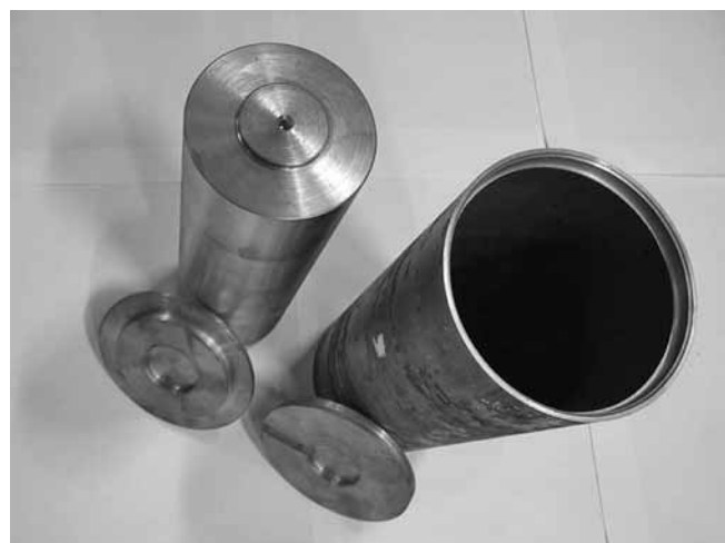
Рис. 1. Детали капсулы для изготовления биметаллической заготовки: сердечник (слева), капсула (справа) и крышки
