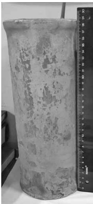
Рис. 2. Биметаллическая заготовка в капсуле после ГИП температуре 1150 °С, давлении 100 МПа с изотермической выдержкой 2 ч.
