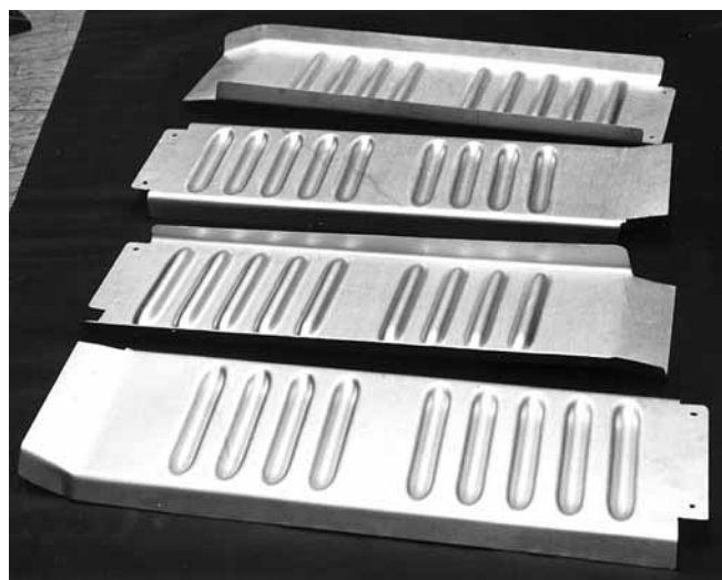
Рис. 9. Панели с элементами жесткости, полученные из листа сплава В-1341Т1 толщиной 1,8 мм методом гибки эластичным пуансоном
