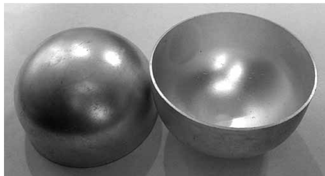
Рис. 8. Сферические донышки после холодной штамповки из листовой заготовки сплава В-1341Т1 после обрезки технологического припуска
