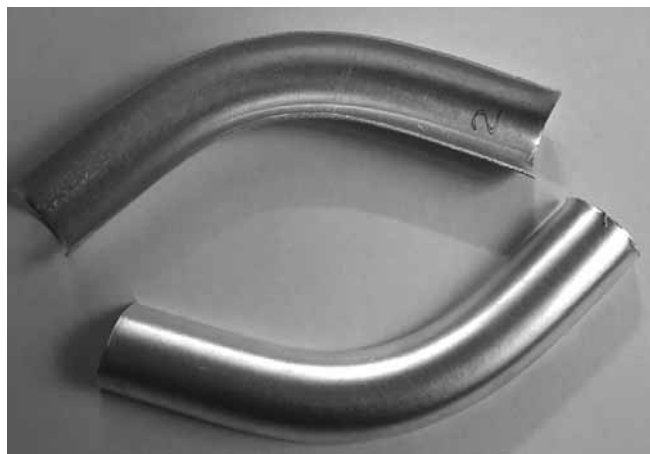
Рис. 7. Штампованные полупатрубки из сплава В-1341Т1 толщиной 1,5 мм
