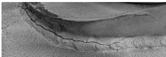
Рис. 2. Характерная трещина, развившаяся в условиях циклических нагрузок
