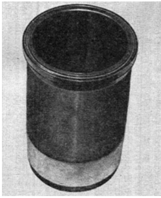
Рис. 6. Гильза цилиндра КамАЗ-740, восстановленная пластинированием под номинальный размер
