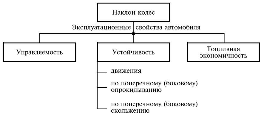
Рис. 8. Схема влияния наклона колеса на эксплуатационные свойства автомобиля
